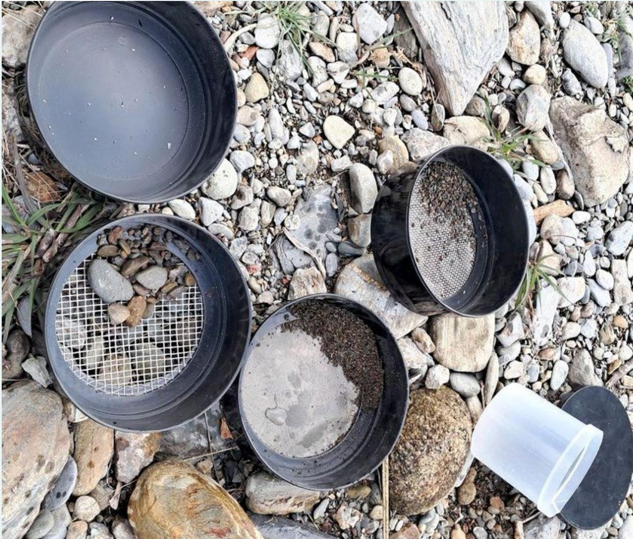
Grace aux tamis nous avons pu trier différentes tailles de roches et y retrouver des galets, des graviers, et du sable.
